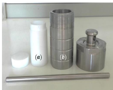
Figure 1 : Matériels de synthèse (a) : Téflon et (b) : Réacteur
