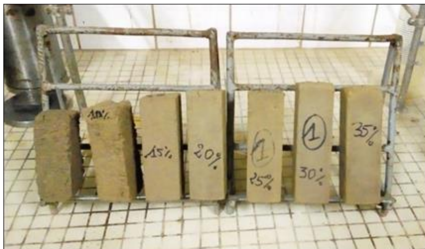
Figure 12 : Image des BTC après érosion pluvieuse
