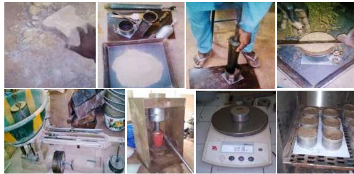
Figure 10: Mode opératoire de l'essai Proctor normal
