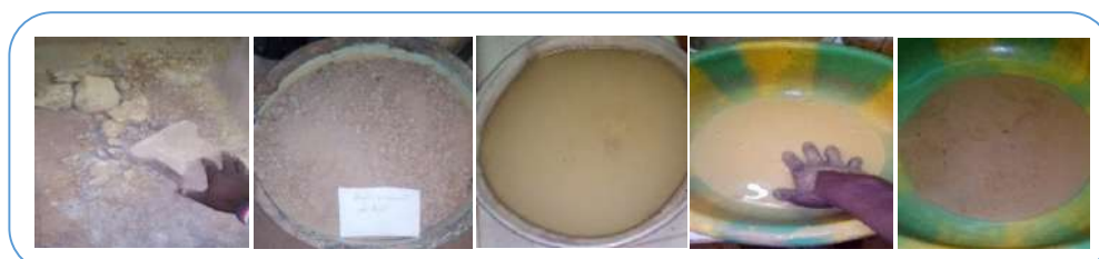
Figure 5: Mode opératoire de l'analyse granulométrique par voie humide
