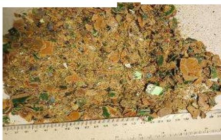
Figure 5: Epoxyde sans composants électroniques après broyage
