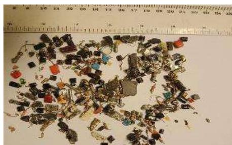
Figure 4 : composants électroniques détruits après broyage
