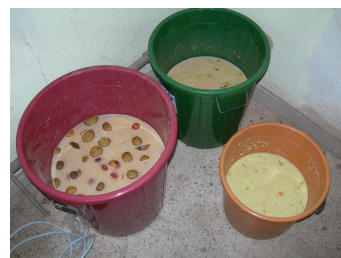
Figure 1 : Extraction aqueuse des déchets d'agrumes
