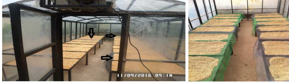
Figure 5 : séchoir type serre montrant les claies suivies lors du séchage du maïs et du riz
