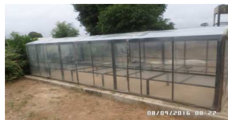
Figure 3 : photo de la maquette fonctionnelle du séchoir serre.
